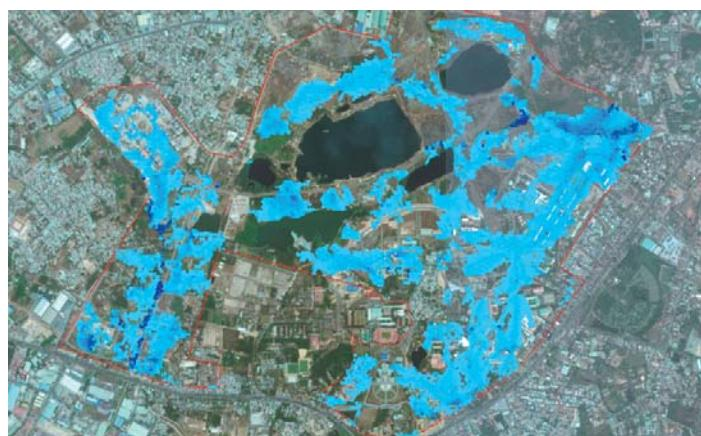
**Hình 3.** Mô phỏng thoát nước mưa Khu Đô thị trong trận mưa lớn ngày 26/9/2016
